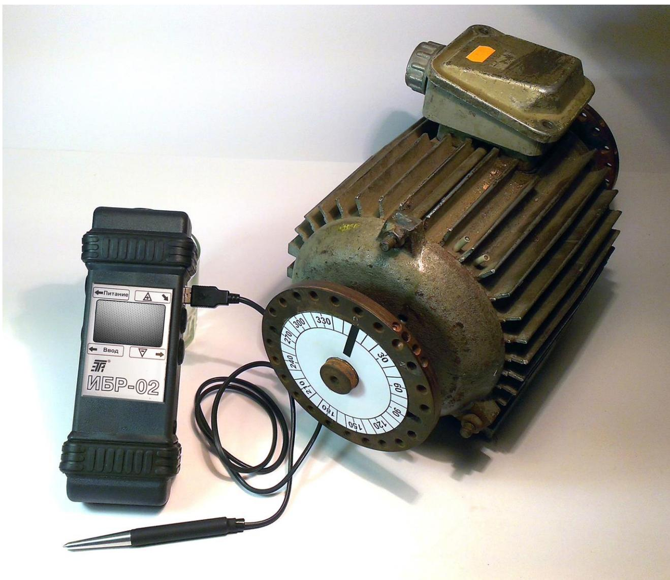
1. Запускаем двигатель и с помощью встроенного стробоскопа определяем частоту вращения ротора.
