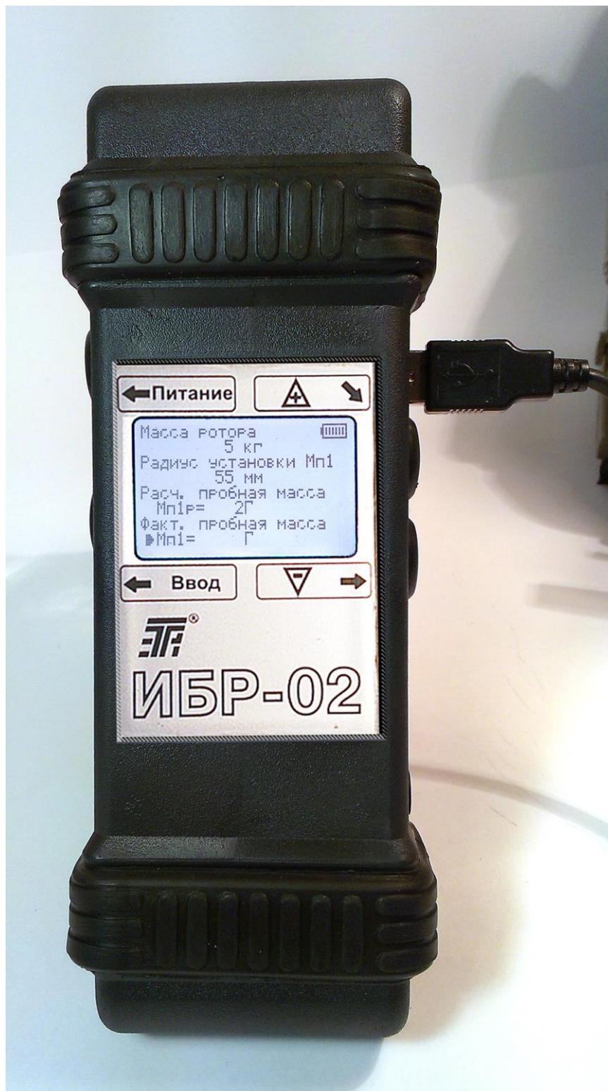
7. Подбираем пробную массу (в данном случае ближайшая из набора пробных масс - 3 г) и устанавливаем её на шкив на радиальной линии, проходящей по возможности перпендикулярно вектору виброскорости V10. Вводим её значение в память прибора.
