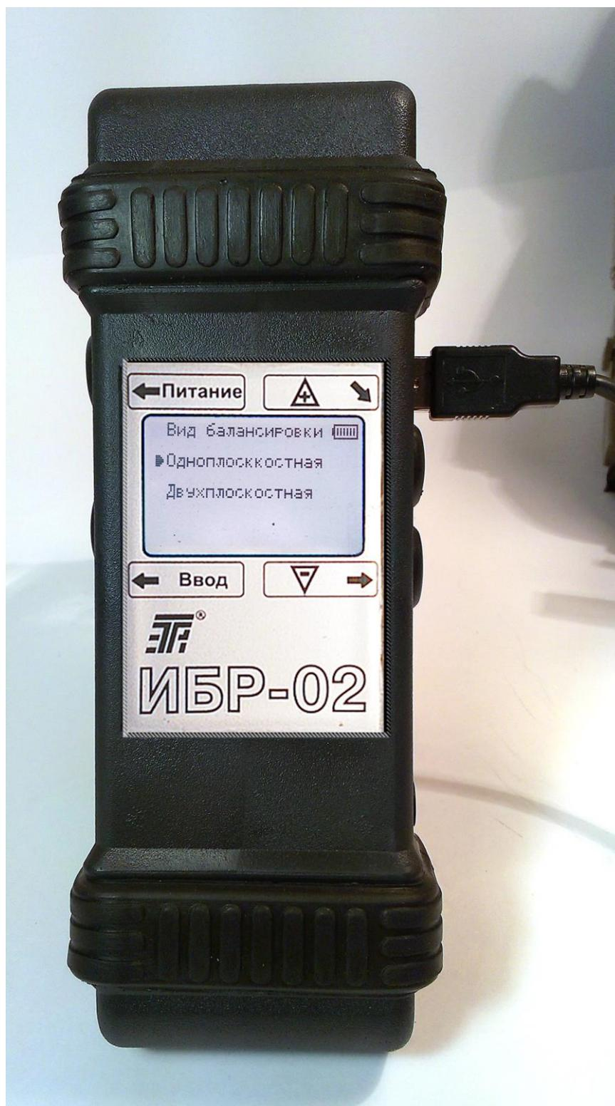
4. Устанавливаем вибродатчик в вертикальном направлении и измеряем виброскорость  $V_{10}$  на частоте вращения  $n$ .
