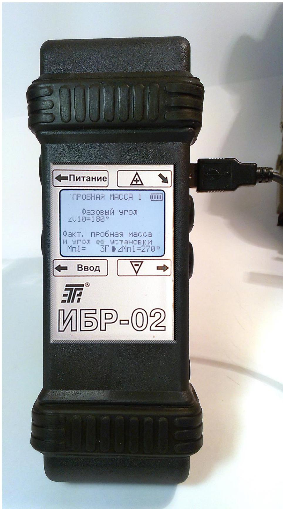
9. Запускаем двигатель и измеряем виброскорость на частоте вращения V11.
