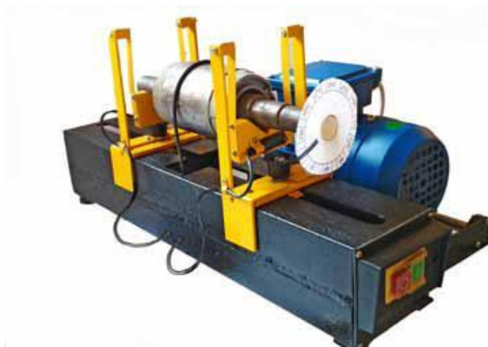
Рис 4.1. Загальний вигляд УБР-1 зі встановленим на ньому ротором
